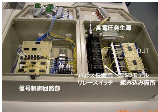
図 4 試作した ESD 試験装置
