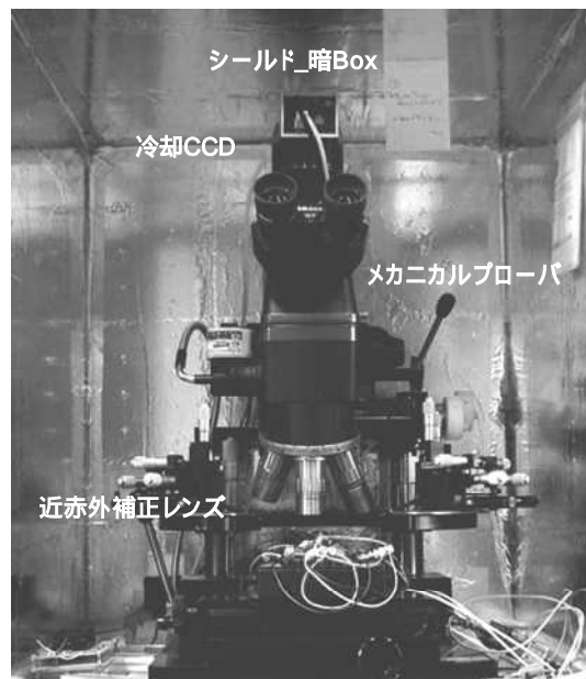
図 11 微小発光を検出する簡易装置
